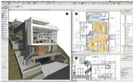
On appelle « **maquette numérique** » d'un ouvrage une maquette 3D, qui comprend ses caractéristiques géométriques (coupes, plans, élévations, etc.) et des renseignements sur la nature de tous les objets utilisés (composition, propriétés physiques, mécaniques, comportement, etc.). Par exemple, une porte est représentée battante ou coulissante, elle est en aluminium avec un double vitrage (attribut) et elle s'ouvre (comportement).
