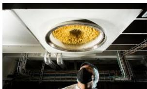
L'usine possède un autre moule duquel jaillissent les vermicelles encore humides. Une série de lames assemblées en forme d'hélice vont être placées sur l'axe central de la machine pour couper les pâtes à la dimension requise.
