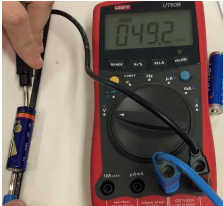
On a fait une fiche technique pour utiliser le multimètre comme un voltmètre.
