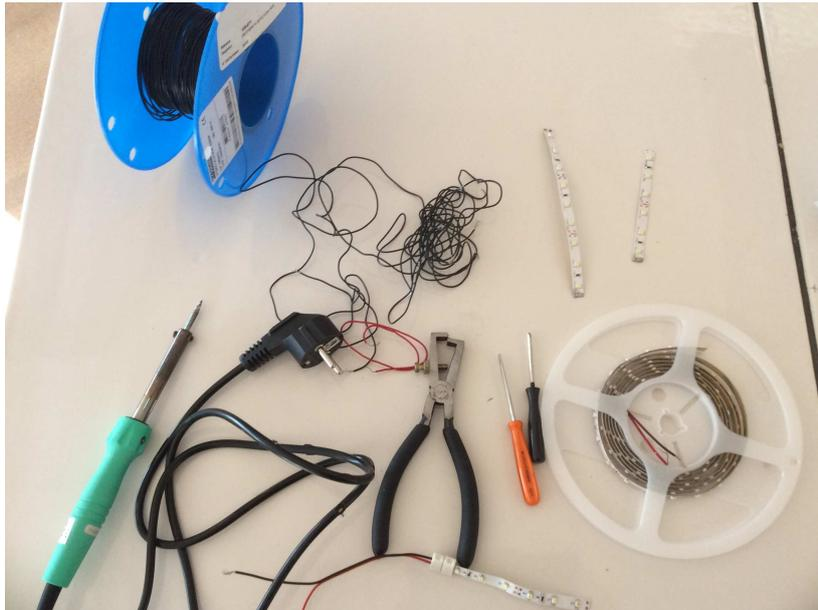
Pour relier deux morceaux de ruban entre eux, on doit relier une des bornes « + » d'un morceau avec une des bornes « + » de l'autre morceau et une des bornes « - » d'un morceau avec une des bornes « - » de l'autre morceau. On utilise des fils rouges pour les bornes « + » et des fils noirs pour les bornes « - » pour se repérer.
